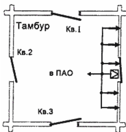
Рисунок 12 - Автономная охрана двери квартирного тамбура с выходом в ПАО
