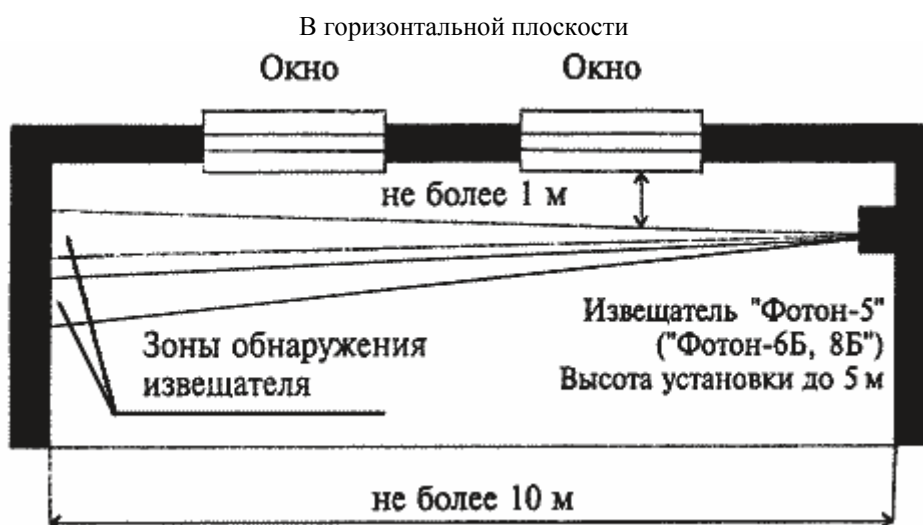
Рисунок 3 - Блокировка окон извещателем объемным пассивным оптико-электронным типа "Фотон" с зоной обнаружения типа "занавес"
