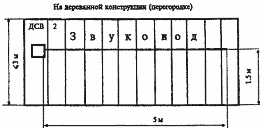
Рис. 7. Блокировка стен, потолка и пола на пролом извещателем поверхностным “Грань-2”
